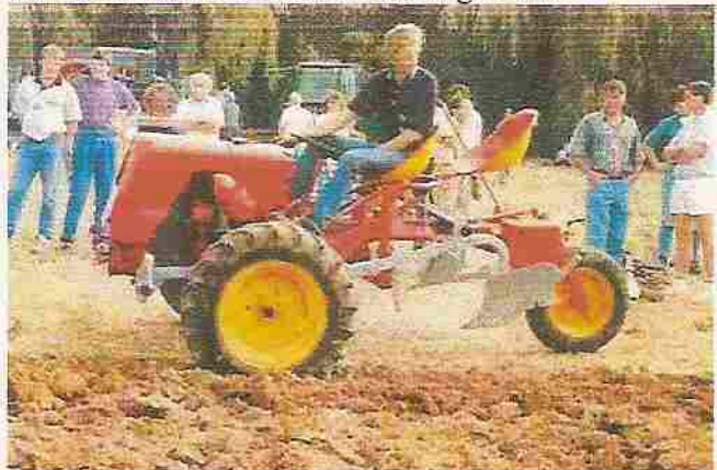
Der Unitrak bei einem Schleppertreffen in Feilbingert in der Pfalz, mit Wechselpflügen die rechts und links am Schlepper angeordnet waren. Der Kraftheber wurde mechanisch betätigt.
