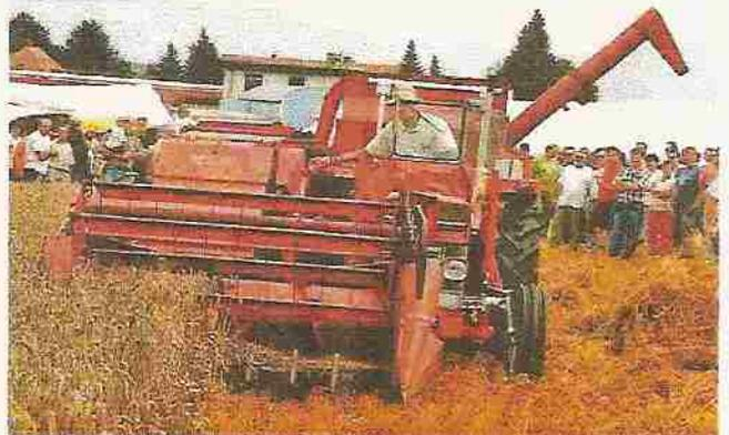
der um den ziehenden Traktor herum angebaut und von der Kardanwelle angetrieben wird.
